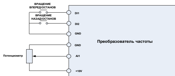
Рисунок 4. Схема подключения цепи управления
